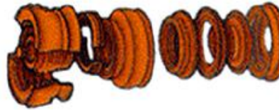
核心模組 Core Major Module • HPC 高壓壓縮器 • Combustor 燃燒室 • HPT 高壓渦輪
